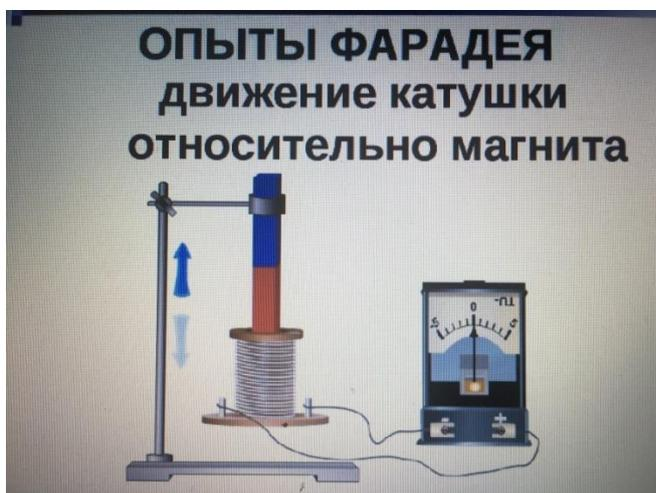
Если быстрее выдвигать или выдерживать магнит, то по отбросу стрелки видно как меняется ЭДС индукции. Видна зависимость ЭДС от скорости движения.
